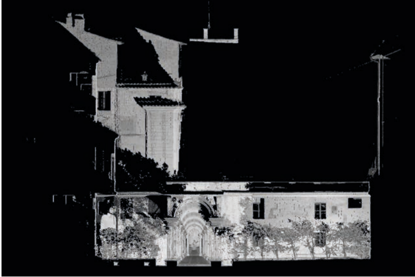
Fig. 4. Rilievo del cortile della Galleria Prospettica di Palazzo Spada ottenuto mediante scansione laser 3D (Immagine di L. Paris).
