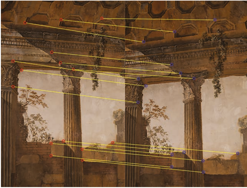
Fig. 5. Estreazione dei punti corrispondenti con indicazione delle linee di matchin .
