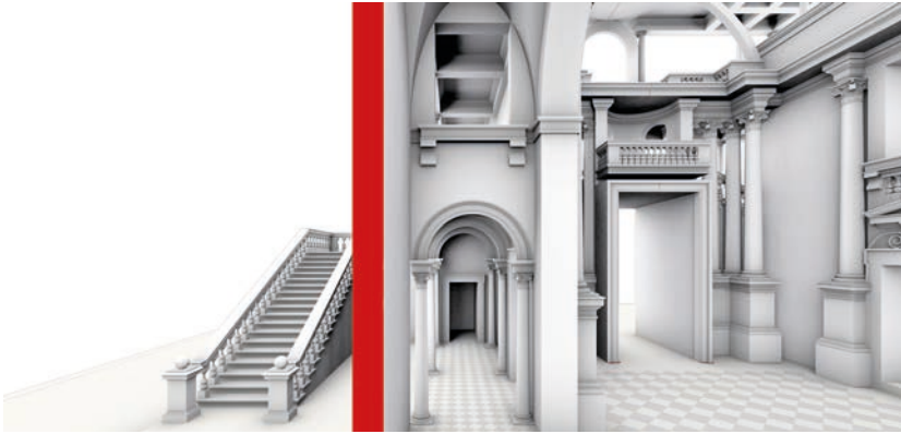
Fig. 11. Ricostruzione 3D dell'ambiente virtuale dedotta dalle prospettive architettoniche apportando quelle correzioni che garantiscono continuità compositiva tra gli ambienti tra loro confinanti.
