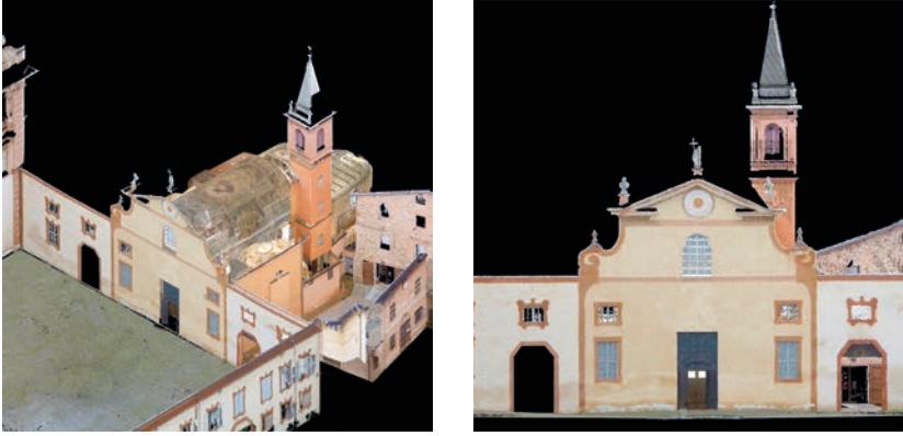
Figg. 12 a, b. A sinistra, assonometria del modello numerico della chiesa e a destra, vista ortografica della facciata dedotta da nuvola di punti.
