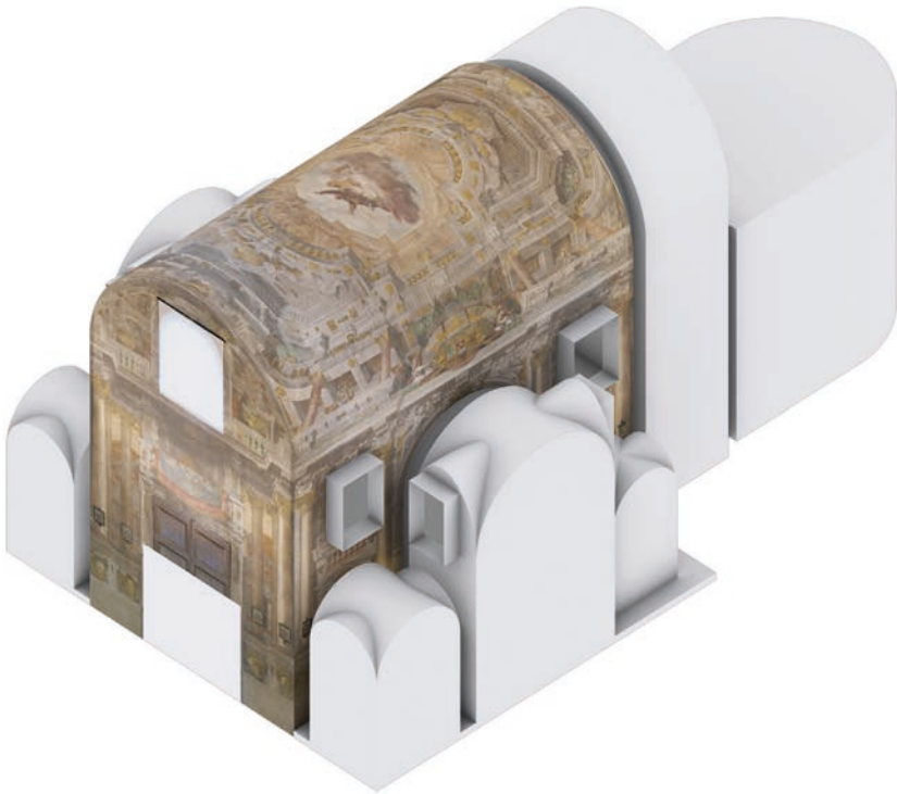
Fig. 15. Applicazione del texture mapping al modello NURBS delle superfici intradossali della fabbrica.
