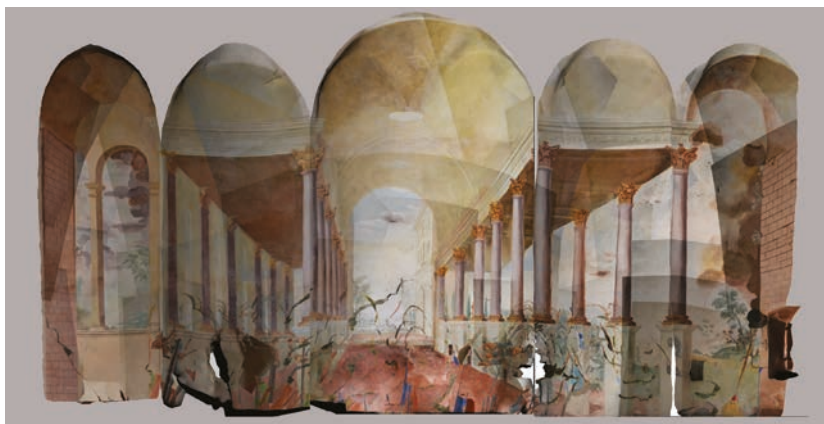
Fig. 8. Fotopiano dell'involucro murario, ottenuto mediante elaborazioni condotte sul modello 3D con l'impiego di Rhinoceros.
