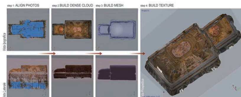
Fig. 13. Tabella illustrante la sintesi del workflow della fotomodellazione tridimensionale ottenuta con il software Agisoft Photoscan. La lettura dei parametri di calibrazione di ogni singolo scatto fotografico permette al programma di trovare il punto di ripresa per ognuno di essi, ricercare i punti comuni nelle fotografie e allineare le immagini fra loro (Align photos). Viene poi costruita nuvola di punti (Build Dense Cloud) e la maglia poligonale 3D costituita da facce triangolari (Build Mesh) e infine applicata la texture cromatica al modello geometrico (Build Texture).
