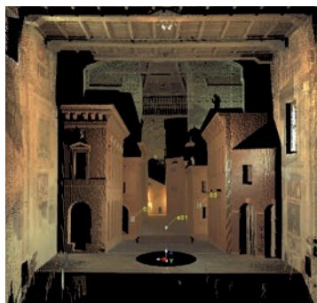
Fig. 4. Teatro all'Antica in Sabbioneta (rilievo con laser scanner).
