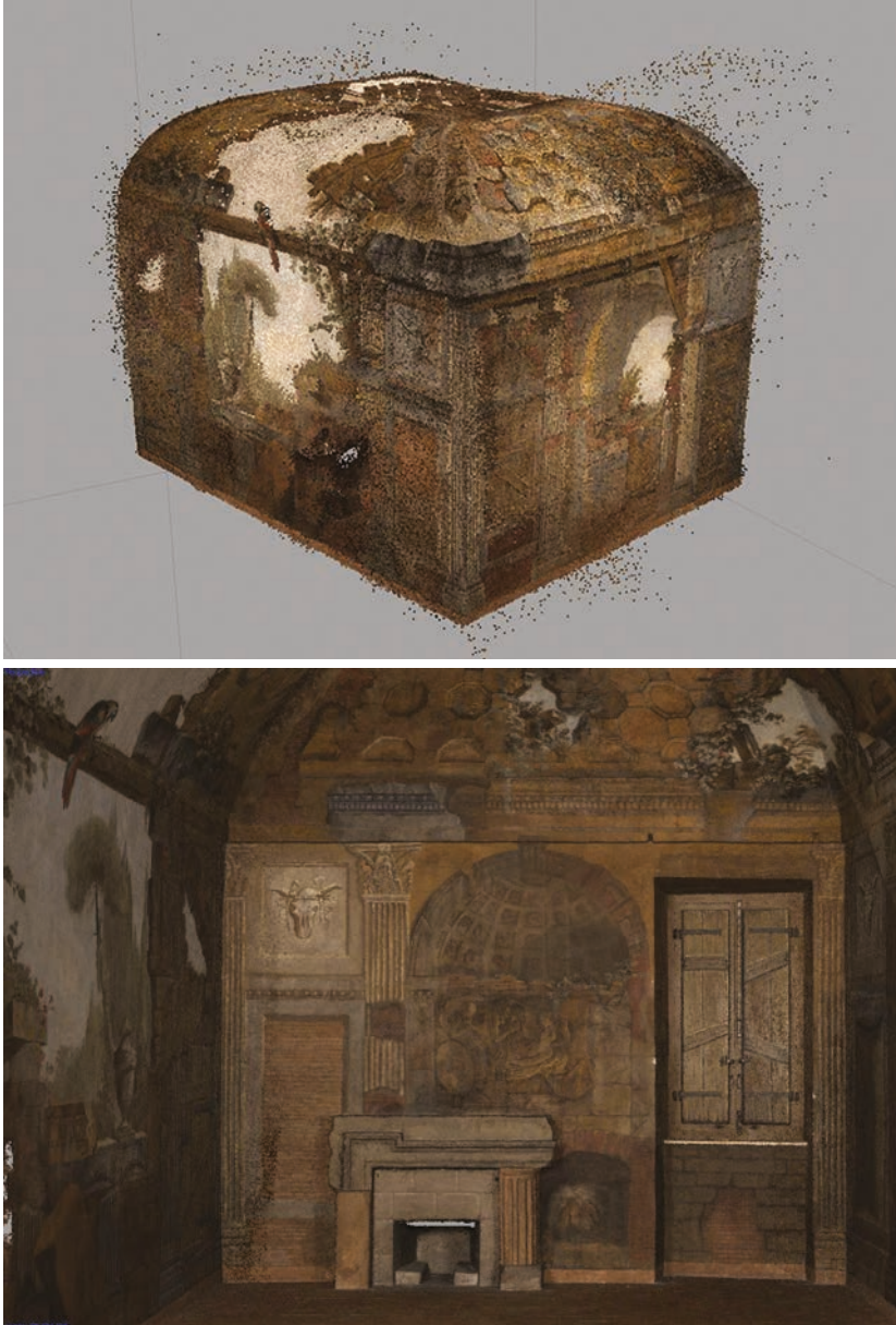
Fig. 9. Sparse point cloud generata dal software di elaborazione (Agisoft-Photoscan).
