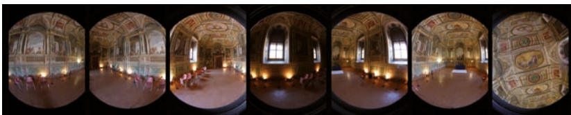
Fig. 10. Fotografie realizzate con obiettivo fish-eye per la colorazione della nuvola di punti.
