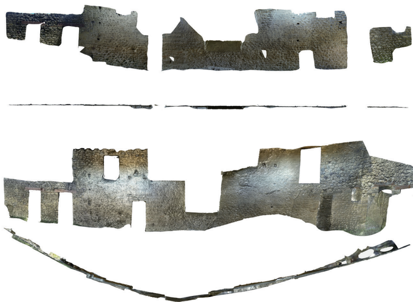
Figg. 11-12. In alto: ortofoto da prese grezze in Recap 360 Photo. In basso: ortofoto da immagini filtrate in Recap 360 Photo.
