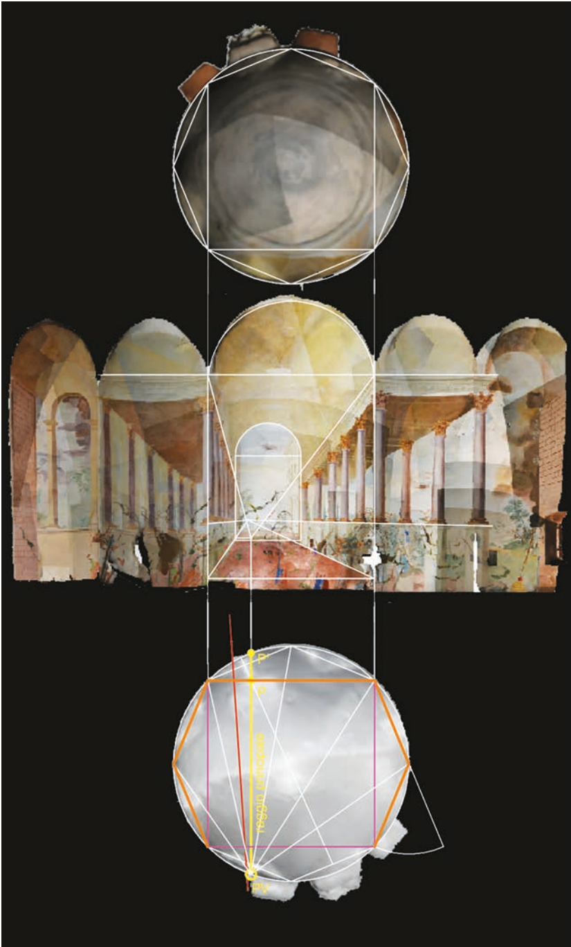
Fig. 9. Analisi grafica e schema interpretativo per individuare il raggio principale e posizionare il punto di vista PV sulla base del fotopiano.
