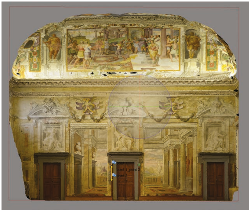
Fig. 8. Prospetto di parte della volta e della parete del salone delle Villa delle Peschiere; elaborazione con il software Agisoft Photoscan.
