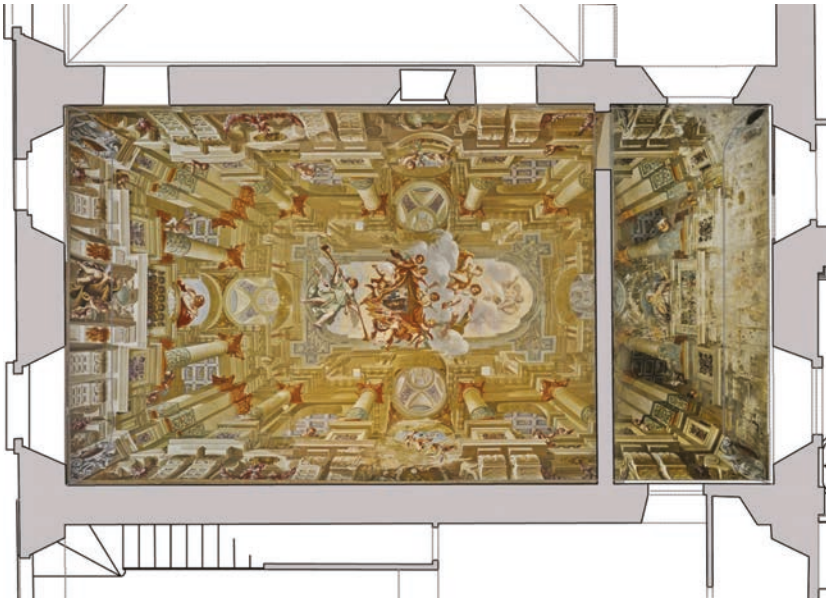
Fig. 5. Ortofoto della volta ricavata da fotogrammetria tridimensionale, inserita nella pianta ipografa della stanza.
