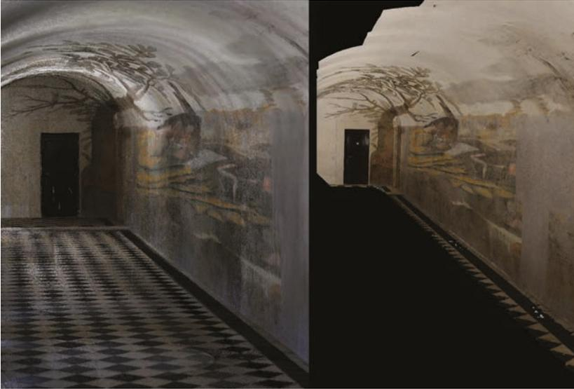
Fig. 6. Confronto tra la nuvola di punti da scansione laser (a sinistra) e il modello mappato ottenuto dalla fotogrammetria automatica (a destra). Elaborazione: E. Trevisan.
