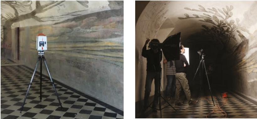
Figg. 2, 3. Metodologie di rilievo impiegate: a sinistra la campagna con ausilio di laser scanner, a destra l'acquisizione delle fotografie per la fotogrammetria automatica.
