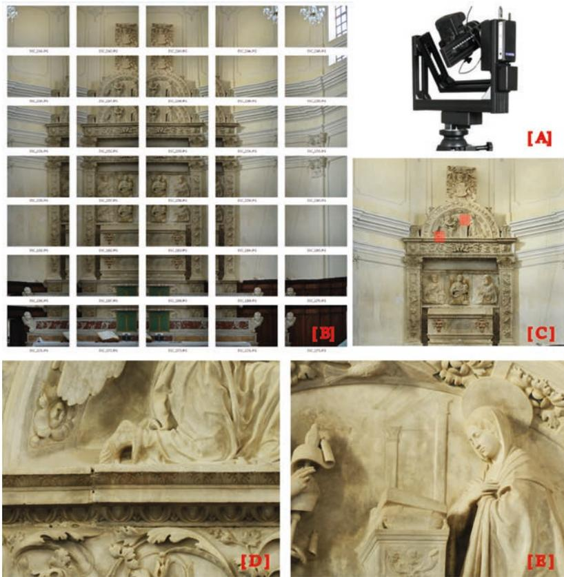
**Fig. 6.** [A] Testa panoramica motorizzata Clauss, modello 'Rodeon VR Station HD'; [B] griglia di acquisizione tramite testa panoramica, posizionata nella navata centrale di fronte l'altare; [C] immagine ad alta definizione ottenuta dall'unione dei 35 fotogrammi, elaborata con applicativo 'Zoomify'; [D] e [E] particolari.
