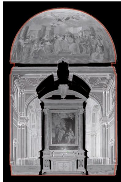
Fig. 7. Proiezione ortogonale dei filari proiettati sulla superficie del muro. Confronto con la *snapshot* ottenuta dalla nuvola dei punti. I due disegni risultano quasi coincidenti.
