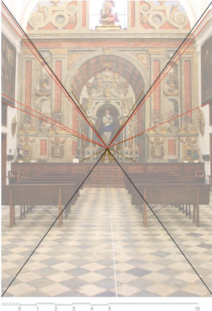
Fig. 30. Comprobación de que la cámara ha sido bien colocada, ya que las fugas de la estancia coinciden con las fugas de la pintura en el punto principal.
