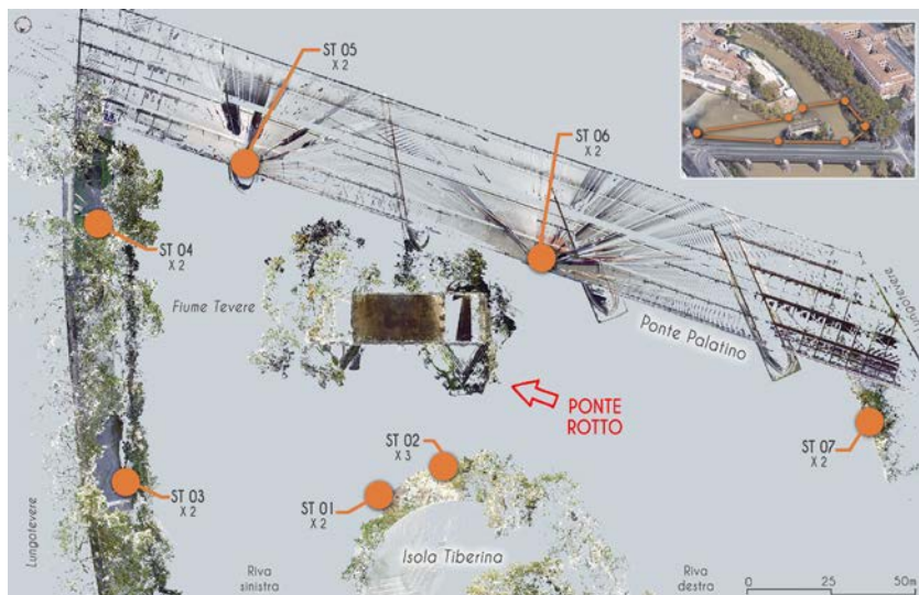
Fig. 5. Nuvola di punti planimetrica con rappresentazione dei punti di stazione (elaborazione di Giulia Umana).
