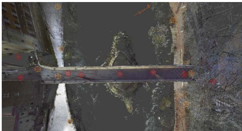
Fig. 7. Nuvola di punti, vista planimetrica, punti di stazionamento (elaborazione di Daniele Maiorino).
