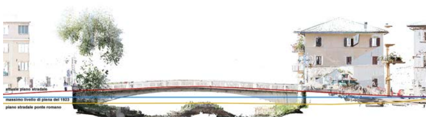
Fig. 6. Sezione longitudinale della nuvola di punti con individuazione delle quote del vecchio e nuovo ponte ed il livello di piena del 1923 (elaborazione di Leonardo Paris).
