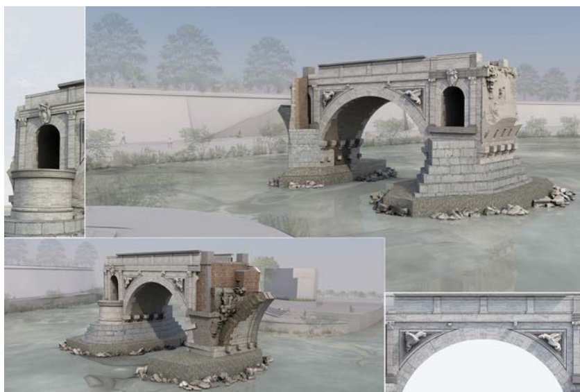
Fig. 10. Ponte Emilio, viste renderizzate. Dall'alto a sinistra: dettaglio del retrobecco semicircolare; vista generale da monte; vista generale da valle; fotopiano del muro di testa di monte (elaborazioni di Giulia Umana).
