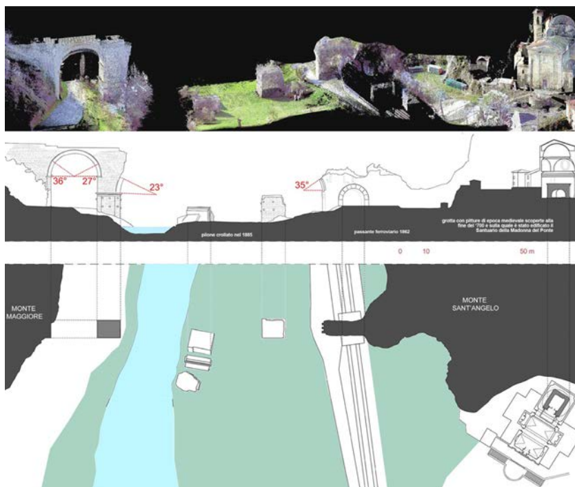
Fig. 7. In alto: point cloud. In basso: restituzione in pianta e prospetto del ponte e del Santuario della Madonna del Ponte (elaborazione di Maria Laura Rossi).
