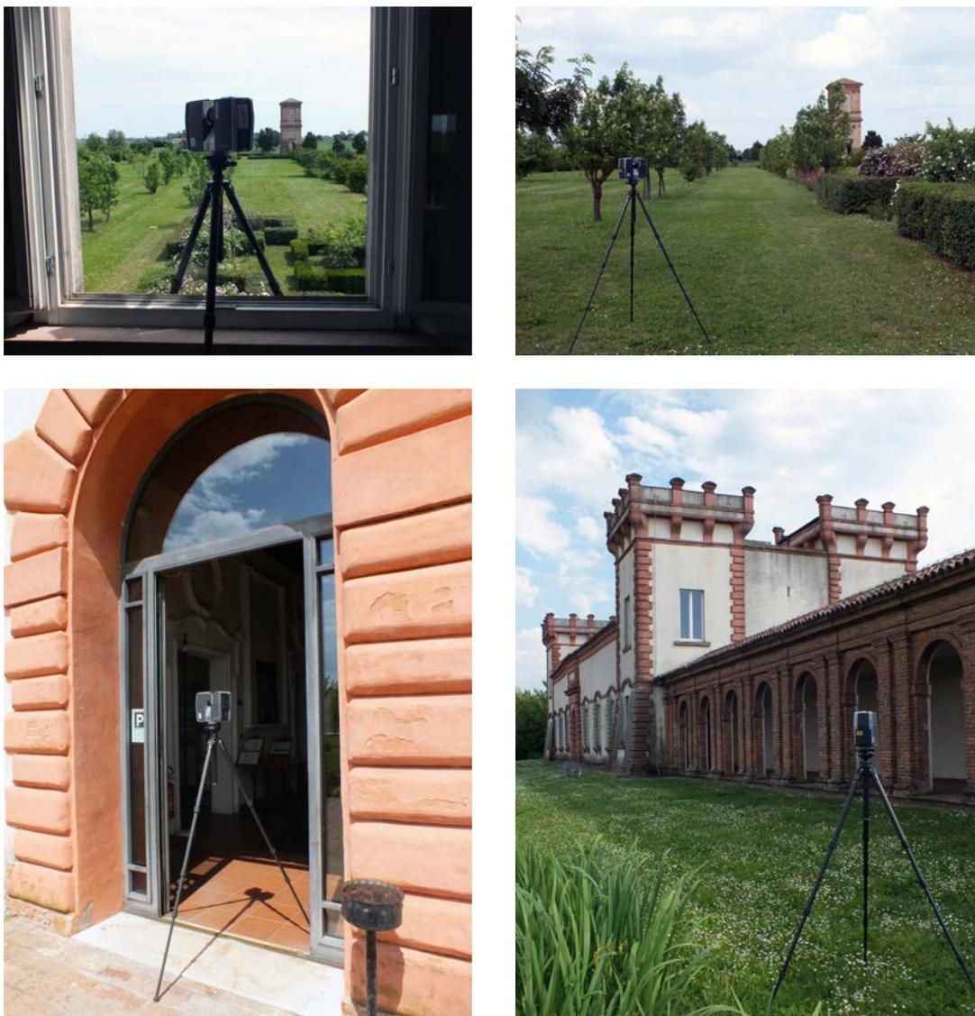
Fig. 5.30. Immagini relative alla fase di rilievo con laser scanner 3D degli interni, degli esterni e di collegamento dentro/fuori.
