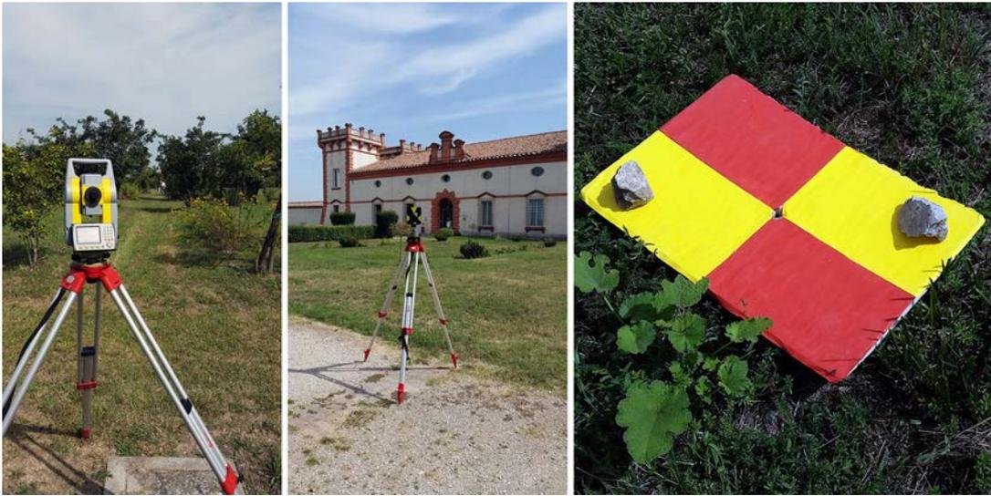
Fig. 5.20. Immagini delle fasi di campagna del rilievo topografico con la strumentazione e una tipologia di target utilizzato.
