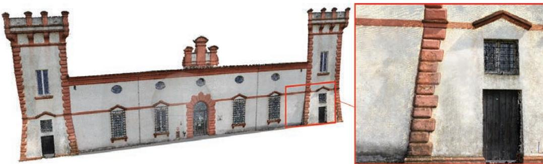
Fig. 5.41. Nuvola di punti della facciata principale e dettaglio ottenuto da processo fotogrammetrico.
