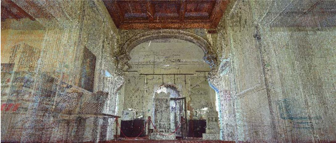
Fig. 2.4. Nuvola di punti colorata di un interno architettonico.
