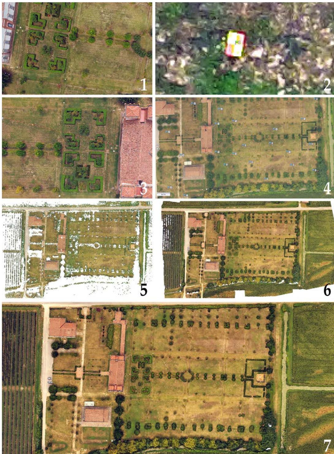
**Fig. 5.38.** Processo di riconoscimento dei PFA nelle immagini attraverso individuazione manuale (1,2) e geometrica (3,4), costruzione della nuvola di punti rada (5), nuvola densa (6) fino al modello numerico texturizzato (7).
