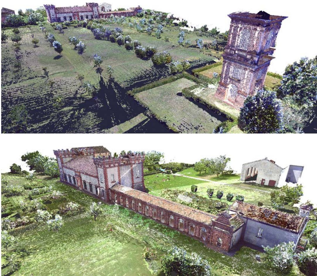
**Fig. 5.45.** Restituzione al tratto della facciata Est e tre viste della nuvola di punti globale e colorata ottenuta dal laser scanner 3D.
