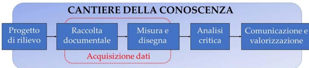
Fig. 2.2. Schema dei principali passaggi del rilievo di un Bene Culturale architettonico.
