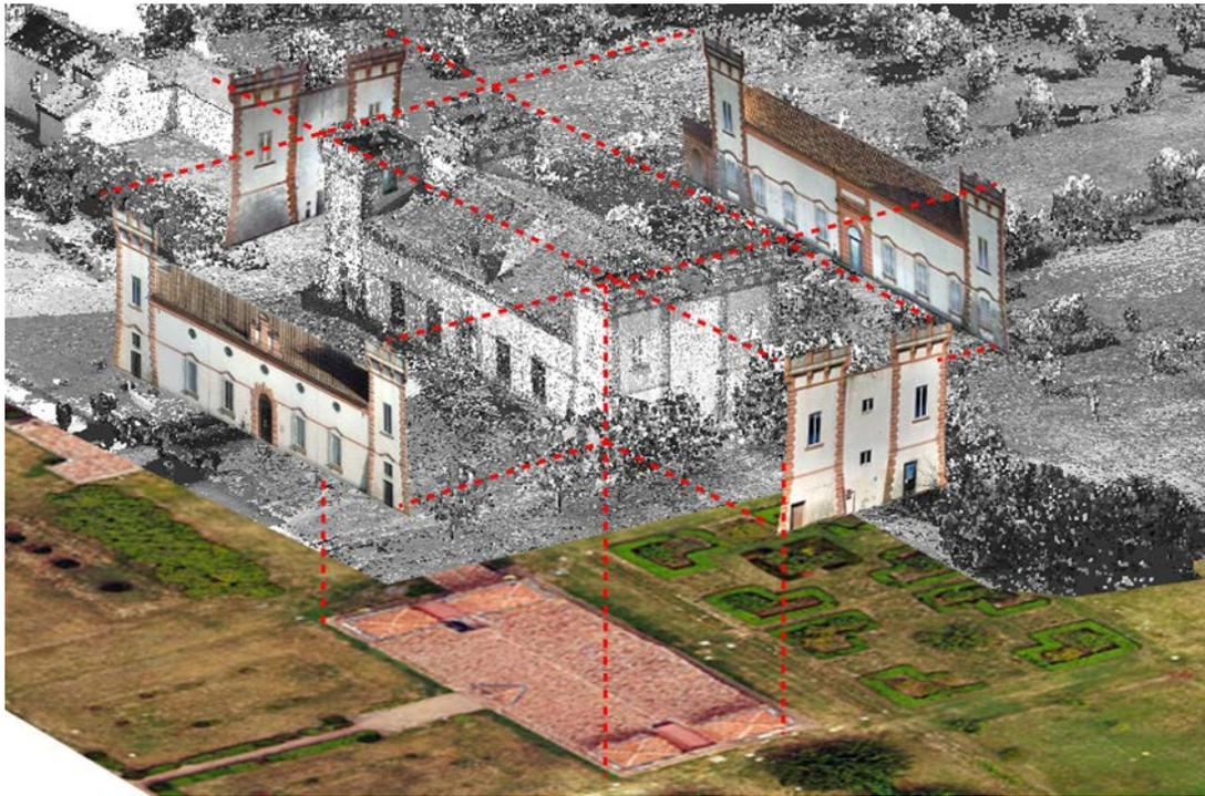
**Fig. 2.9.** Sistema informativo composto da nuvola di punti completa, ottenuta dalla integrazione dei dati *image-based* e *range-based*, con le orto-immagini territoriali e delle facciate principali del Palazzo.
