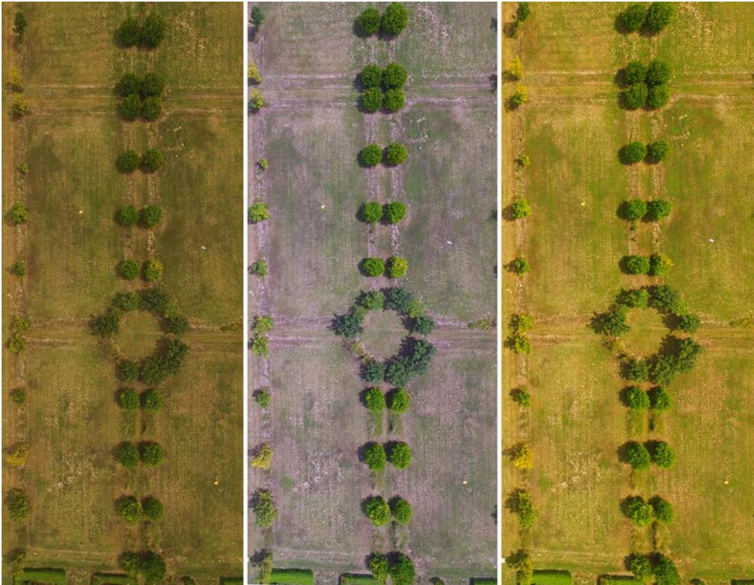
Fig. 5.27. Sequenza di immagini acquisite in tre differenti voli con il drone Phantom 4. Le prime due immagini da sinistra sono state acquisite con una scelta di tempi di esposizione automatica, mentre la terza con una impostazione fissa. Dalle immagini si può notare il problema della variazione di luminosità in funzione delle impostazioni della camera e delle condizioni climatiche, che possono in talune circostanze variare durante il volo.
