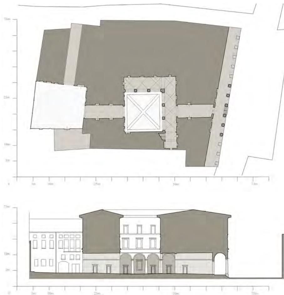
Figg. 5.24, 5.25. Rappresentazione in pianta e in sezione del cannocchiale prospettico, viene evidenziata l'alternanza di spazi al chiuso e all'aperto graficizzata con colori diversi.
