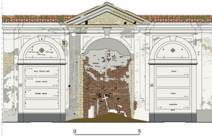
Fig. 4. Cimitero delle 366 fosse, prospetto nord, particolare, quadro materico (elaborazione grafica dell'autore).
