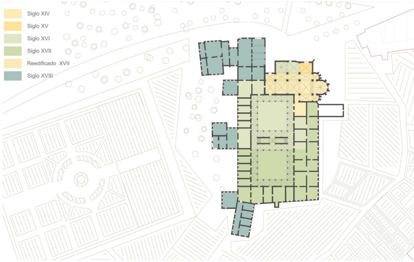
Fig. 2. Convento de San Francisco con indicación de las sucesivas ampliaciones y reformas (elaboración gráfica per el autor).
