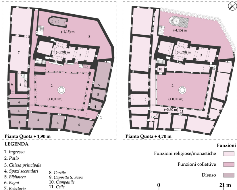
Fig. 4. Planimetrie a varie quote con individuazione degli spazi e del grado di fruizione (elaborazione grafica dell'autrice).
