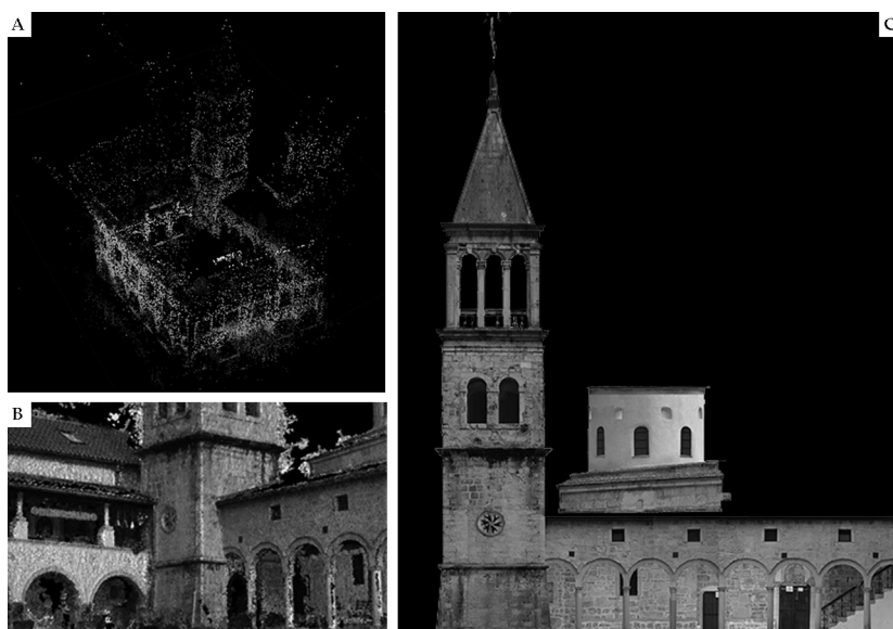
Fig. 3. Il rilievo fotogrammetrico. Elaborazione della nuvola dei punti [A-B]; Fotopiano della Chiesa e del Campanile, lato Nord-Est [C] (elaborazione grafica dell'autrice).
