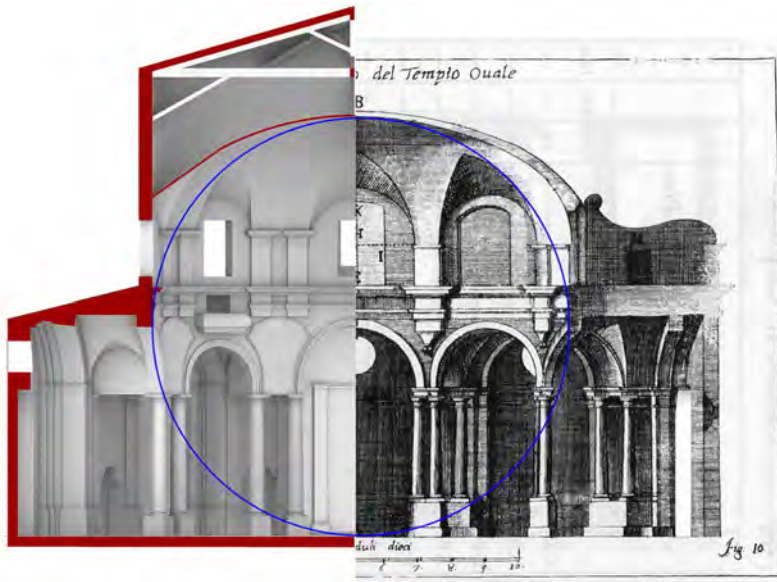
Fig. 7. Sezioni trasversali della riconfigurazione virtuale della chiesa di Sant'Ignazio a Mazara (a destra) e del "Tempio a pianta ovale" di Amico, da Amico 1750, fig. 10 (a sinistra), in blu la circonferenza che definisce le altezze (elaborazione grafica di Mirco Cannella).
