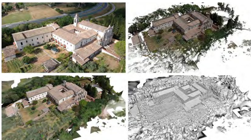
Fig. 6. L'immagine mostra una fotografia da drone e il modello mesh tridimensionale texturizzato del convento di San Bartolomeo, ottenuto con tecnica SfM (elaborazione grafica di Federico Ferrari).
