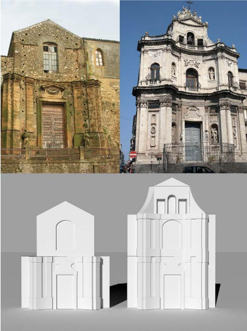
Fig. 11. Confronto prospettico della chiesa dei Teatini (in alto a sinistra) con quello della chiesa di San Placido (in alto a destra). In basso il modello ricostruttivo (elaborazione grafica dell'autrice).
