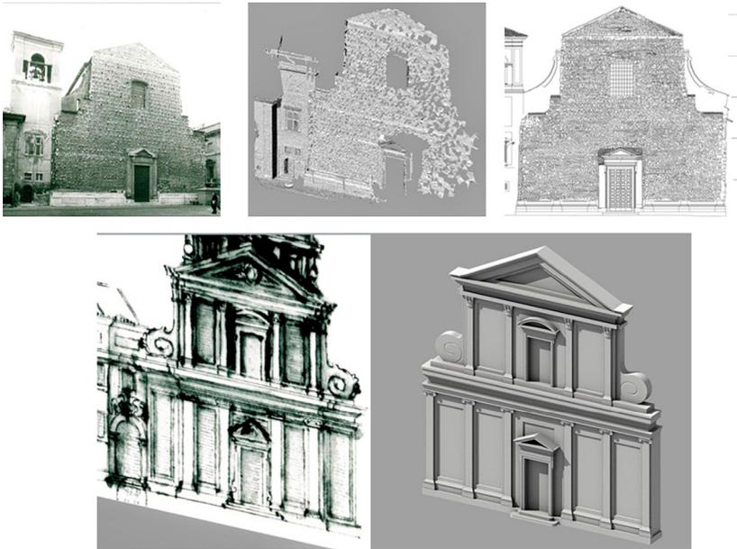
**Fig. 1.** Chiesa di Santa Margherita a L'Aquila, ipotesi di completamento. Le immagini in sequenza: foto della facciata attuale; nuvola di punti; restituzione; disegno di progetto datato 1625; modello ricostruttivo della facciata (elaborazione dell'autore).
