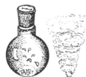
REAZIONE CHIMICA TRA IL CARBURIO DI CALCIO E L'ACQUA
