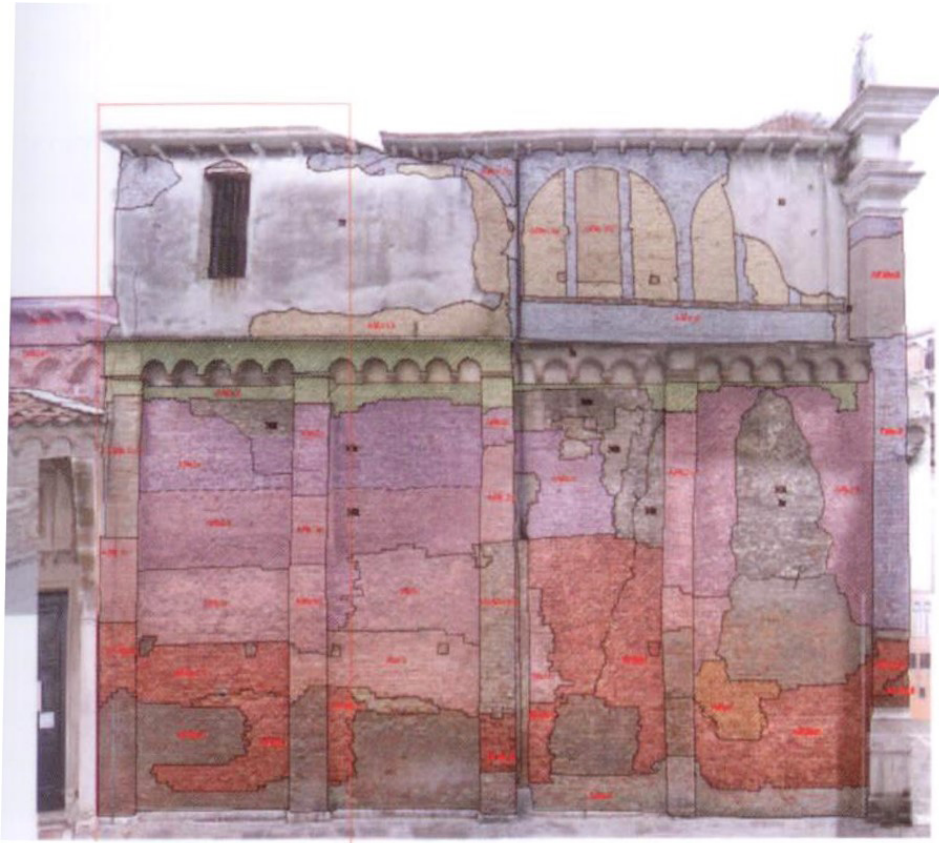
Fig. 30. Stratigraphic units map. From F. Doglioni, Nel restauro. Progetti per la architettura del passato , (IUAV Documenti), Marsilio, Venezia 2008.
