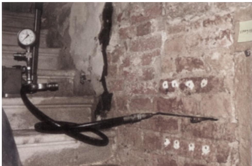
Fig. 4. Martinetto singolo . From G. Doglioni, G. Mirabella, Venezia: forme della costruzione, forme del dissesto , Libreria Cluva Editrice, 2011, p. 208.
