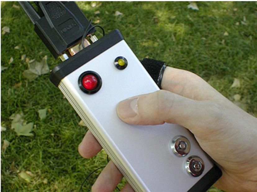
**Fig. 8.** Christian Nold, *Bio Mapping*, 2004. Nell'immagine il dispositivo impiegato per misurare la risposta galvanica della pelle (GSR). Courtesy dell'artista.
