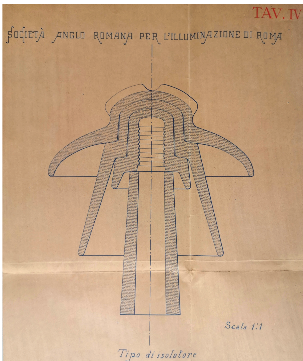
Fig. 1. Isolatore per la linea di trasporto Subiaco-Tivoli (Archivio Storico ENEL, Napoli).
