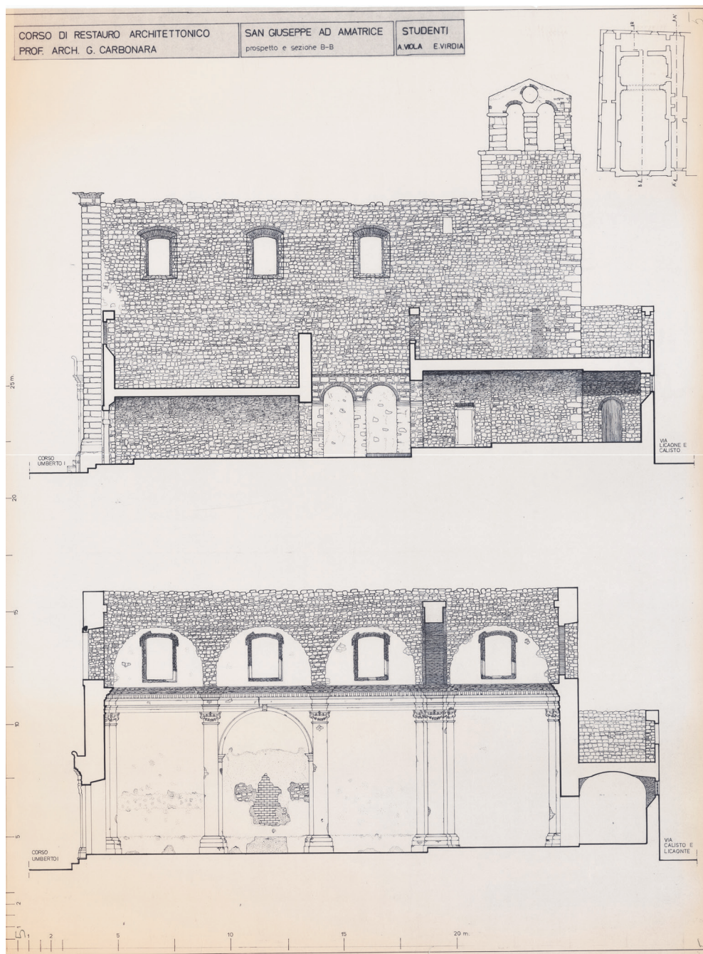
Fig. 5. Ex chiesa di S. Giuseppe ad Amatrice, rilievo architettonico, sezioni (ADF- DSDRA, CA 186, tav. 5, studenti A. Viola e E. Viridia).
