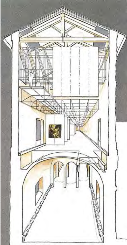
Fig. 9 - Canali drawing for the exhibition room. (From G. CANALI, Ampliamento della Galleria Nazionale e restauro della Pilotta: il progetto , in Galleria Nazionale di Parma , Milano 1997)
