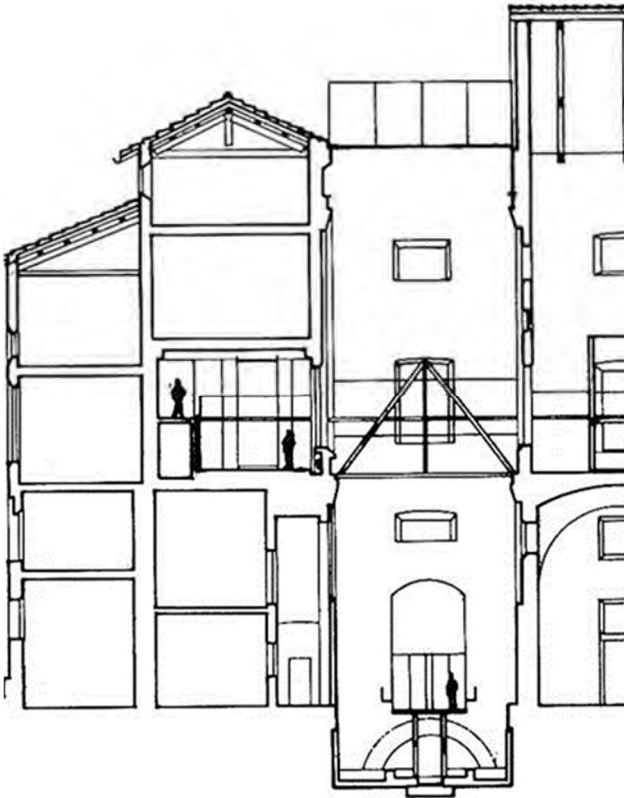
Fig. 6 - Drawing of the metal walkways connecting rooms. (From A. C. QUINTAVALLE, Il "caso Parma": progetti per l'area della Pilotta/Guido Canali. Galleria Nazionale nel Palazzo della Pilotta, Parma , in "Domus", n° 683, Edizioni Domus, Milano 1987, pp. 38-44)
